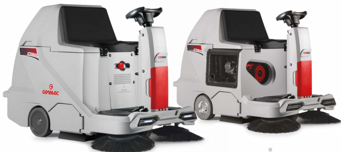
CS60 Hybrid Verzija sa baterijskim napajanjem i motorom sa unutrašnjim sagorevanjem.
